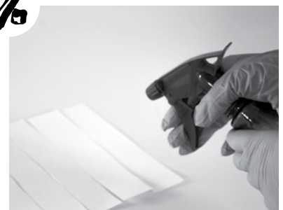
Doe een mondkapje op en spuit voorzichtig het mengsel op de strookjes papier op een donkere plek en laat deze drogen.
