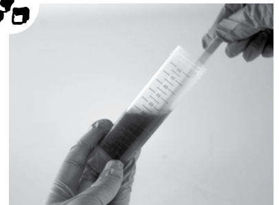
Voeg 20 ml koud gedemineraliseerd water toe en roer totdat het ammoniumijzer(III)citraat volledig is opgelost.
