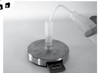
Voeg 20 ml koud gedemineraliseerd water toe en roer totdat het zout volledig is opgelost.
