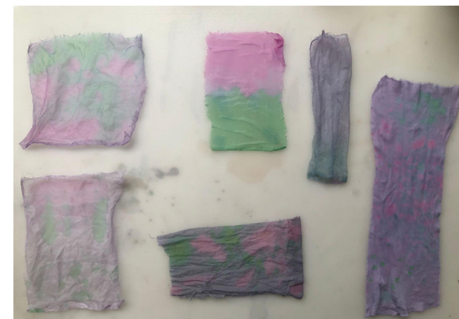
Voorbeelden van textiel geverfd met rode kool en bewerkt met verschillende basische en zure oplossingen
