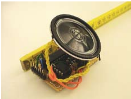
De binnenkant van een Meshy-module: chip met luidspreker.
