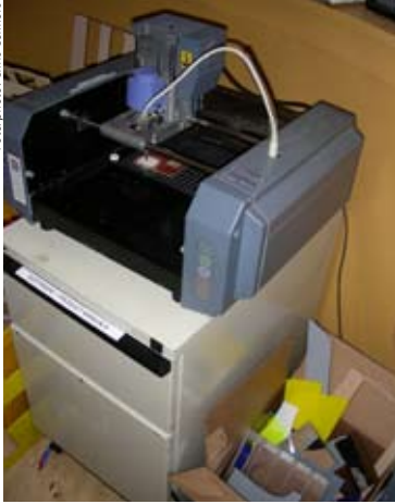
Een freesmachine voor printplaatjes. Modella, a milling machine for circuit boards.
