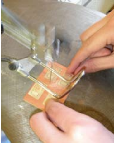
Close-up van het loszagen van 4 printplaatjes. Close-up of the cutting of four circuit boards.
