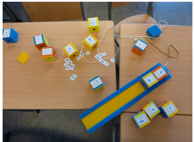
Voor het tweede prototype werd het formaat van de blokken teruggebracht, zodat de blokken beter door kinderen te hanteren waren. Bij dit prototype legden de kinderen de blokken van de juiste klanken/letters op een leesplankje, zodat het hele woord gevormd en beluisterd kon worden.
